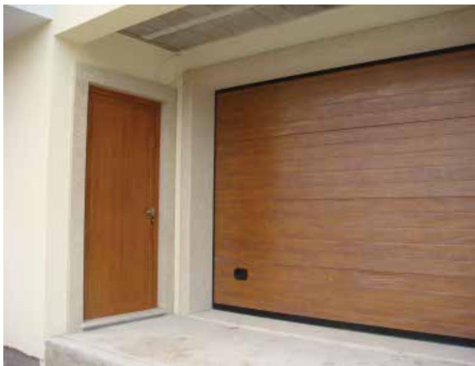
Portões seccionados constituídos por painéis deslizáveis na posição vertical através de dobradiças laterais, encontrando-se na parte superior uma mola de aço tratado de alta qualidade, que suaviza o seu movimento.
